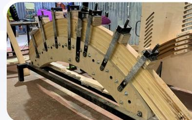
**Цех ГКЗ** (Гнутоклееных заготовок) обеспечивает самостоятельное производство **гнутого бруса**, для ряда наших изделий, что улучшает контроль качества и снижает зависимость от кооперации.
