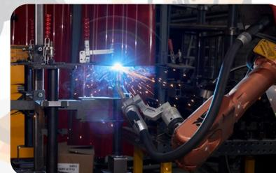
Частично **автоматизированное** производство. Роботы по сварке, гибке металла исключают человеческий фактор и даже незначительные ошибки в производстве.
